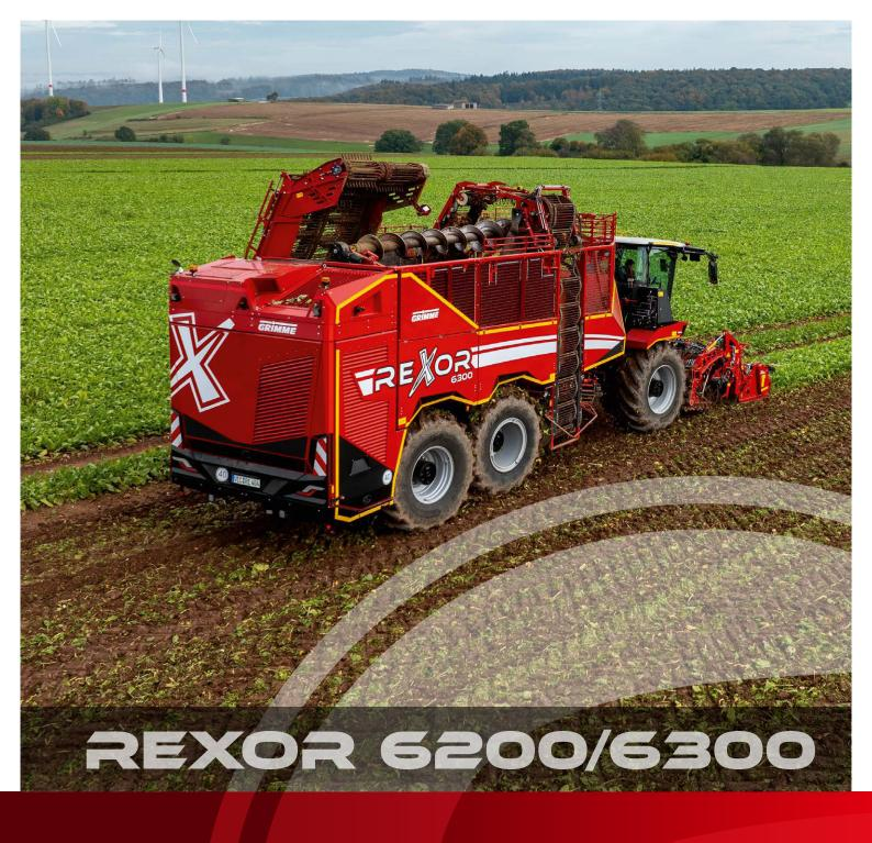
Новейшее поколение 6-рядных свеклоуборочных комбайнов оснащено кабинами последнего поколения, инновационным выкапывающим устройством, множеством систем поддержки рабочего процесса, облегчающих работу оператора, и разработано для эффективной уборки свеклы, корневого цикория и сельдерея
