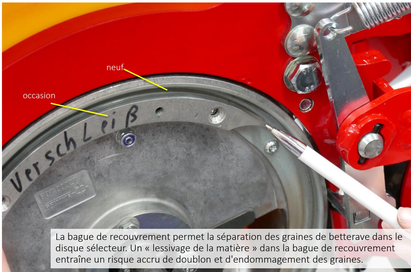
La bague de recouvrement permet la séparation des graines de betterave dans le disque sélecteur. Un « lessivage de la matière » dans la bague de recouvrement entraîne un risque accru de doublon et d'endommagement des graines.
