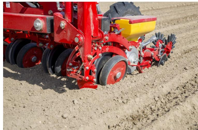
Pour contrôler la dépose des graines de betterave, parcourez env. 10 à 20 m avec la machine abaissée, arrêtez-vous, puis descendez du tracteur.
