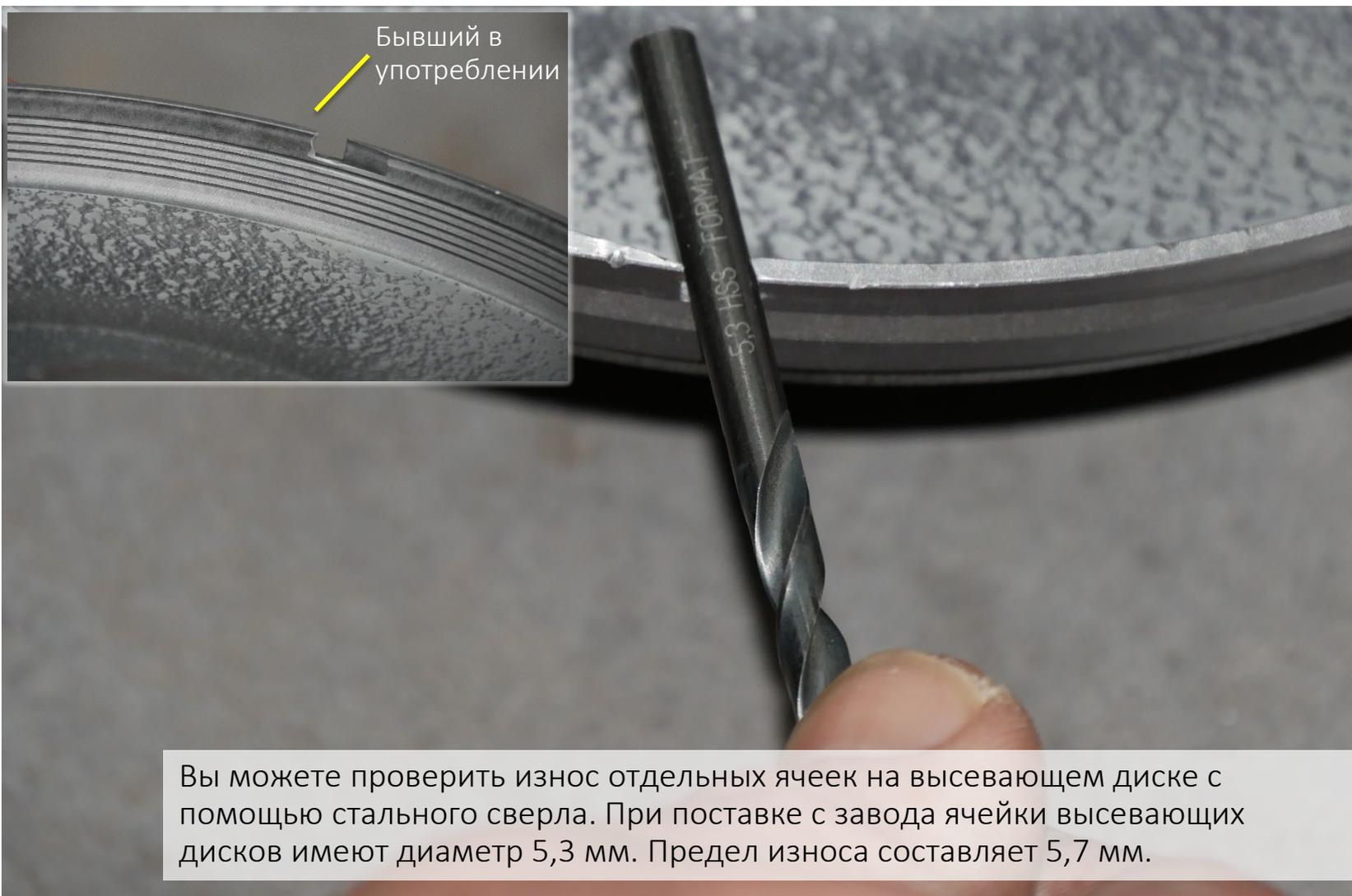
Вы можете проверить износ отдельных ячеек на высеваящем диске с помощью стального сверла. При поставке с завода ячейки высеваящих дисков имеют диаметр 5,3 мм. Предел износа составляет 5,7 мм.
