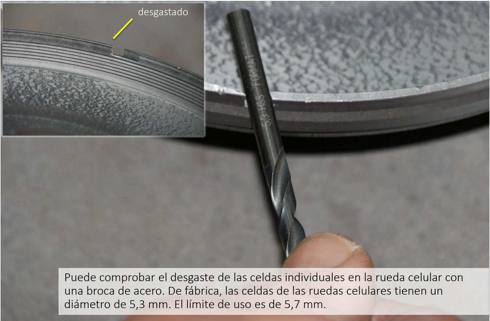
Puede comprobar el desgaste de las celdas individuales en la rueda celular con una broca de acero. De fábrica, las celdas de las ruedas celulares tienen un diámetro de 5,3 mm. El límite de uso es de 5,7 mm.
