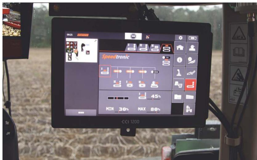
Mit MemoryControl ist die zentrale Verstellung der Antriebe und Trenngeräte möglich. Einstellparameter wie z. B. Drehzahlen, Einstellwinkel und Grenzwerte können für verschiedene Erntebedingungen gespeichert und situationsbedingt schnell per Knopfdruck abgerufen werden. Bis zu 8 Programme können so hinterlegt werden, um von schonend bis leistungsorientiert roden zu können.
