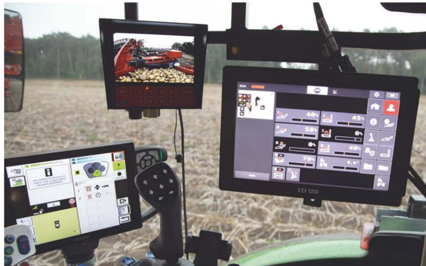
Durch die automatische Drehzahl-anpassung der Trenngeräte und des Verlesetisches an die Erntebedingungen schafft das optionale Speedtronic eine Erhöhung der Erntegutshonung bei gleichzeitiger Steigerung der Flächenleistung und eine umfangreiche Entlastung des Fahrers.
