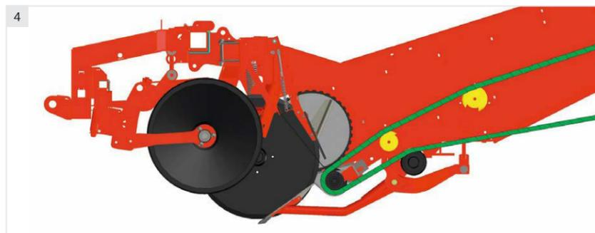
Für den Umbau von Schwadaufnahme (3) auf Dammtrommel-aufnahme (4) ist ein bewährtes Schnellwechselsystem integriert.
