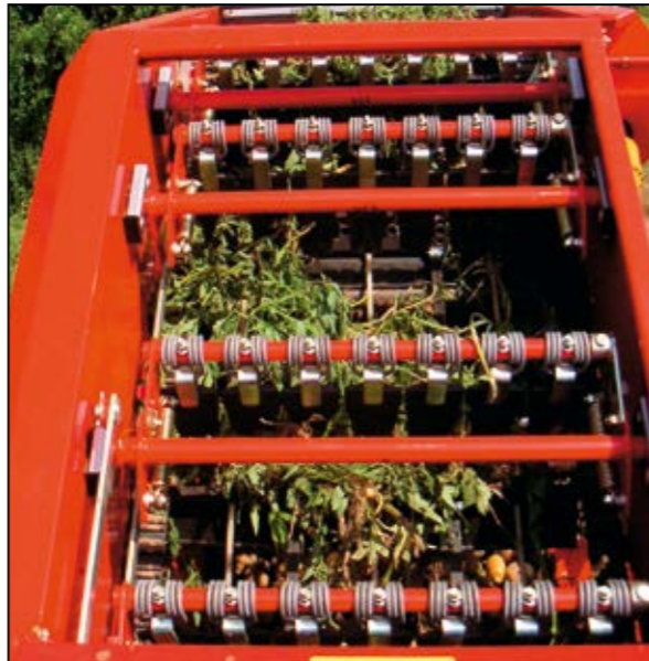
Cuidado óptimo: Cinta de broza con lengüetas de arrastre de PU blando (Paso de 210 cm o bien 280 cm entre lengüetas).
