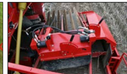
SB 900, cepillos dobles (opción): Mayor rendimiento de separación en terrenos pedregosos.
