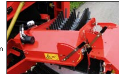
La velocidad de la cinta de dedos es ajustable hidráulicamente en forma continua.
