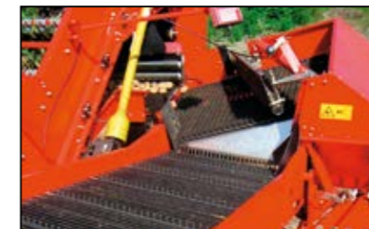
Tipo NB: Accionamiento de la cinta y rodillo deflector por el sistema hidráulico del tractor.
