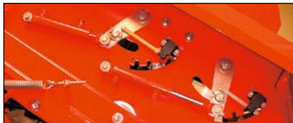
Opcional, ajustables vía técnica digital: Las seis filas de paletas de desbroce (cada una, 3 arriba y 3 abajo).
