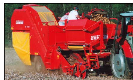
SE 75-30: voor gemiddelde oppervlakten, bijzonder compacte bouwwijze, bunker voor 3000 resp. 3300 kg
