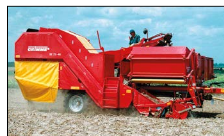
SE 75-40: voor grote oppervlakten, bijzonder compacte bouwwijze, bunker voor 4000 resp. 4300 kg
