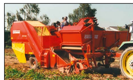
SE 75-20: voor kleine oppervlakten, bijzonder compacte bouwwijze, bunker voor 2000 resp. 2300 kg
