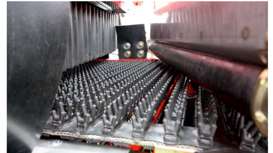
Finalement, le rouleau grattoir assure une séparation de pommes de terre et de déchets sans pertes.
