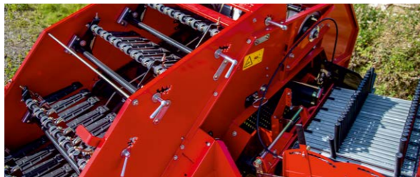
Réglage manuel : les 6 peignes grattoirs sur la chaîne effaneuse
