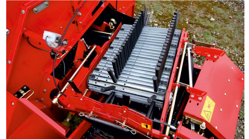
La vitesse du tapis à doigts est réglable en continu de façon hydraulique.
