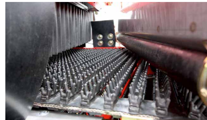
Вальцовые скребки обеспечивают заключительное отделение примесей, без потерь картофеля.
