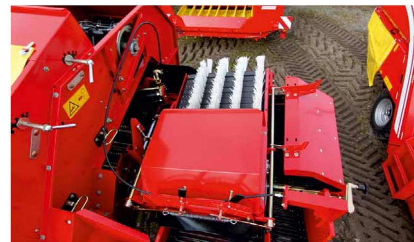
Сепарирующее устройство варианта SB: для каменистых почв
