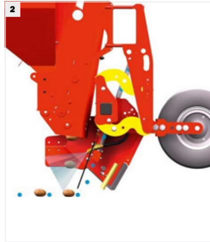
Guidage en profondeur au choix : guidage sur parallélogramme des quatre socs de plantation en commun à l'aide de deux roues de jauge (3) latérales
