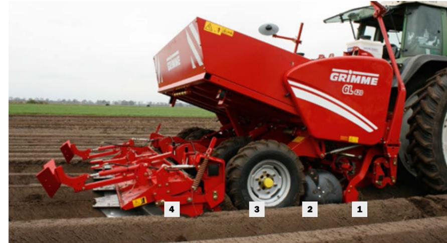
La petite différence décisive : le soc de plantation tiré (1) entoure l'élément de plantation et est équipé à l'aide de la roue de jauge. La butte est constituée en amont des roues (3), par les gros disques de recouvrement de 510 mm (2). La cape formeuse confère à la butte sa forme définitive (4).
