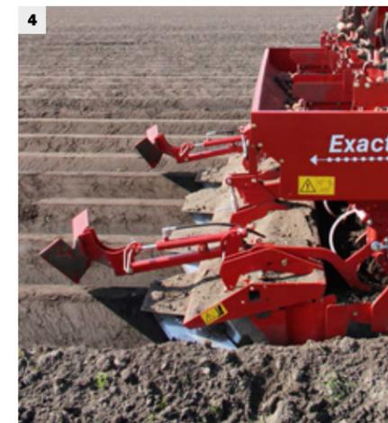
Le débit des tapis (3) est piloté de façon précise par des capteurs. La butte est constituée à l'aide de la cape formeuse (4) dès la dépose des tubercules.
