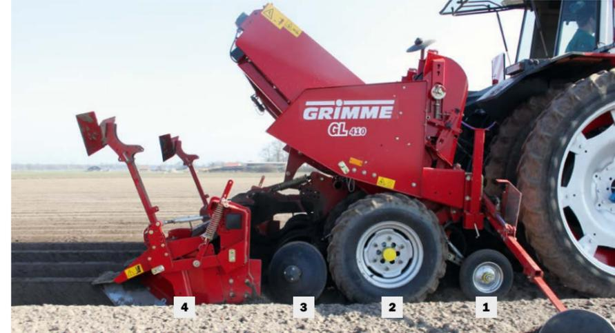
Le soc de plantation tiré (1) entoure l'élément de plantation et peut être équipé d'une roue de jauge. La butte est constituée en aval des roues (2), par des disques de recouvrement de 460 mm (3), suivis de la cape formeuse (4) donnant à la butte sa forme définitive.
