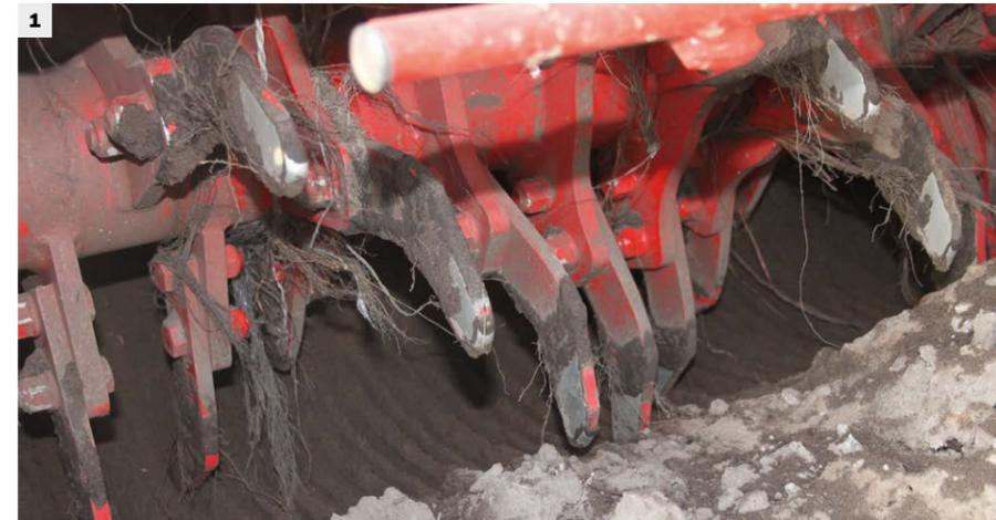
La GR 300 permet de travailler sur toute la largeur (1). Les 110 dents sont disposées de façon spiraloïdale, d'où une préparation uniforme.
