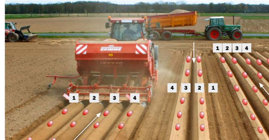
Si la planteuse est équipée d'un entraînement mécanique commun des organes de plantation, l'écart entre les rangs peut être réglé en 27 niveaux de 14 à 50 cm.
