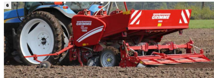
Trémie basculante hydraulique plate de 2000 kg (6)
