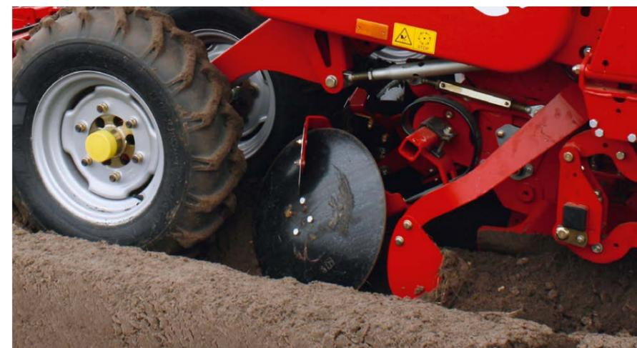
Les disques de recouvrement qui se trouvent directement derrière les socs de plantation constituent la butte de façon quasi-intégrale. La cape formeuse finit le volume et le lissage de la butte.
