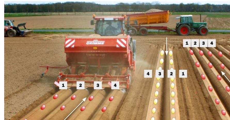
Lorsque la machine est équipée d'un entraînement hydraulique commun des organes de plantation, l'alimentation hydraulique s'effectue à partir du tracteur et permet des écarts progressivement réglables entre les rangs.
