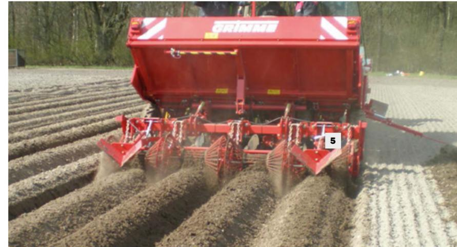
En option, la butte peut être également formée à l'aide d'un rouleau cage (5) assurant une structure émiettée et favorisant l'échange d'air et d'humidité dans la butte.
