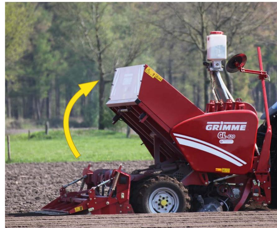
Soulagement du conducteur pendant les longues journées de travail : un capteur automatique en amont des éléments de plantation saisit le niveau de remplissage devant les godets. L'automatisme de la trémie assure le remplissage optimal et une alimentation en douceur (option).
