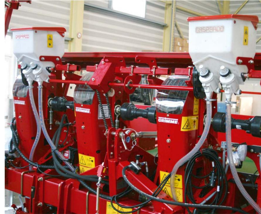
Protection combinée des végétaux : La GL 420 peut être équipée en option avec un distributeur de micro-granulés contrôlé et homologué. Le dosage est simplement réglé à l'aide de molettes sur le réservoir. A l'aide du coupleur électrique, les distributeurs peuvent être facilement commandés à partir du tracteur. Le granulé est dispersé de façon fiable à proximité des tubercules.
