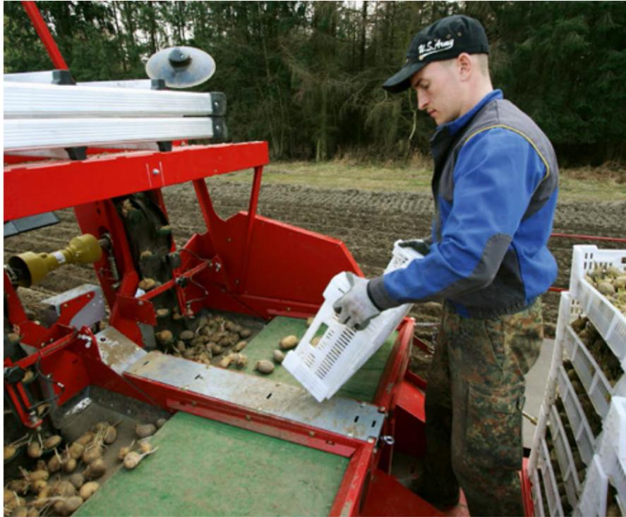
Module à fond mouvant avec passerelle confortable pour un remplissage ergonomique du fond vibrant
