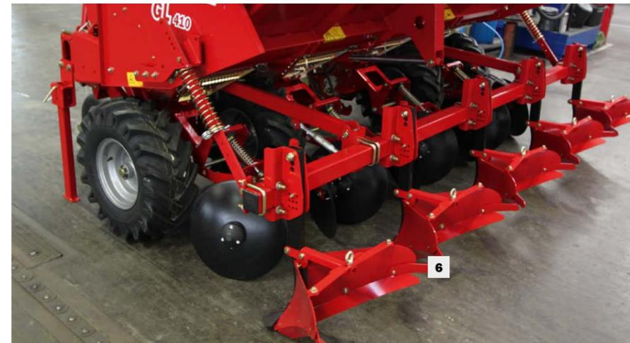
Il s'avère également possible de constituer la butte à l'aide de butteurs (6) derrière les disques de recouvrement.
