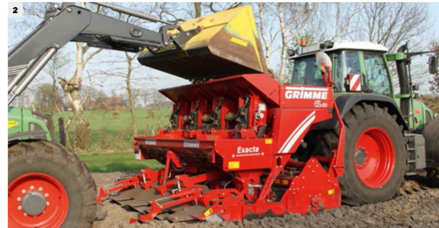
La trémie (2) peut être remplie en douceur à l'aide d'un dispositif de chargement à l'avant ou d'un élévateur de remplissage.
