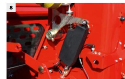
Pour couper chaque élément de plantation et faire des passages de traitements, chaque élément peut être coupé séparément de façon mécanique (7) ou plus confortablement électromécanique (8) à partir de la cabine, ou automatique (en option).
