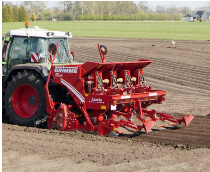
En série, l'Exacta est équipée d'un entraînement hydraulique, d'un pupitre de commande GBT 850 et d'un détecteur de manque.
