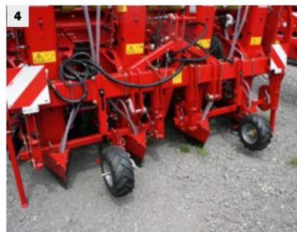
A l'aide de vérins hydrauliques (2), un capteur automatique (1) pilote la hauteur de la barre à dents (3) et de la cape formeuse (4).
