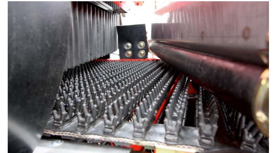
Zgarniacz wałkowy zapewnia oddzielenie domieszek z ziemniaków bez strat.
