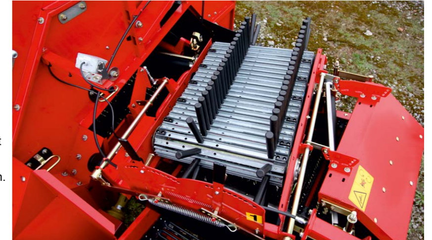
Prędkość taśmy z długimi palcami można regulować bezstopniowo hydraulicznie.
