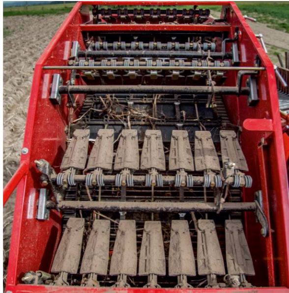
Optymalna ochrona bulw: taśma łęczinowa z miękkimi poliuretanowymi zgarniaczami (odstęp co 210 mm)
