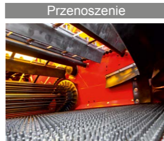
Efektywne oddzielenie i delikatne przenoszenie bulw
