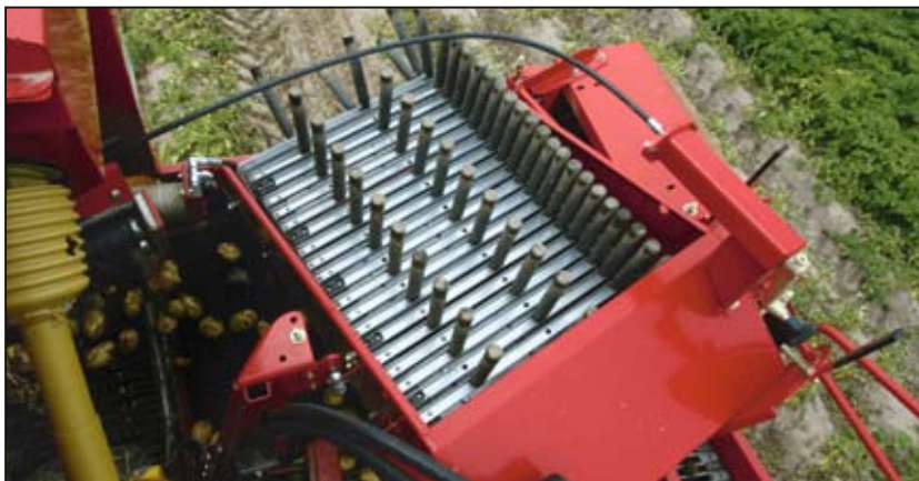
Hastigheten til fingerbeltet kan justeres trinnløst ved hjelp av hydraulikken.
