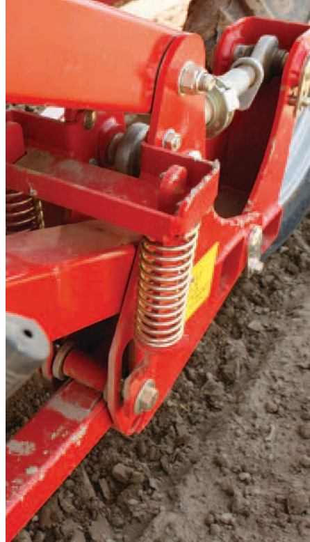
Chapa formadora del caballón FLOW-BOARD con ajuste mecánico de profundidad de plantación en GB 215.
