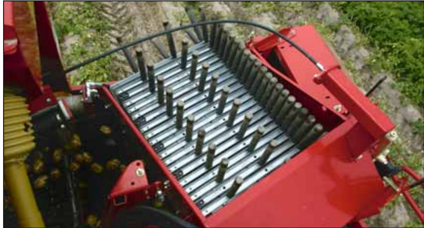
De snelheid van de vingerband is traploos hydraulisch verstelbaar
