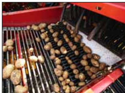
Lonende optie: de 3-rollen voorsortering
