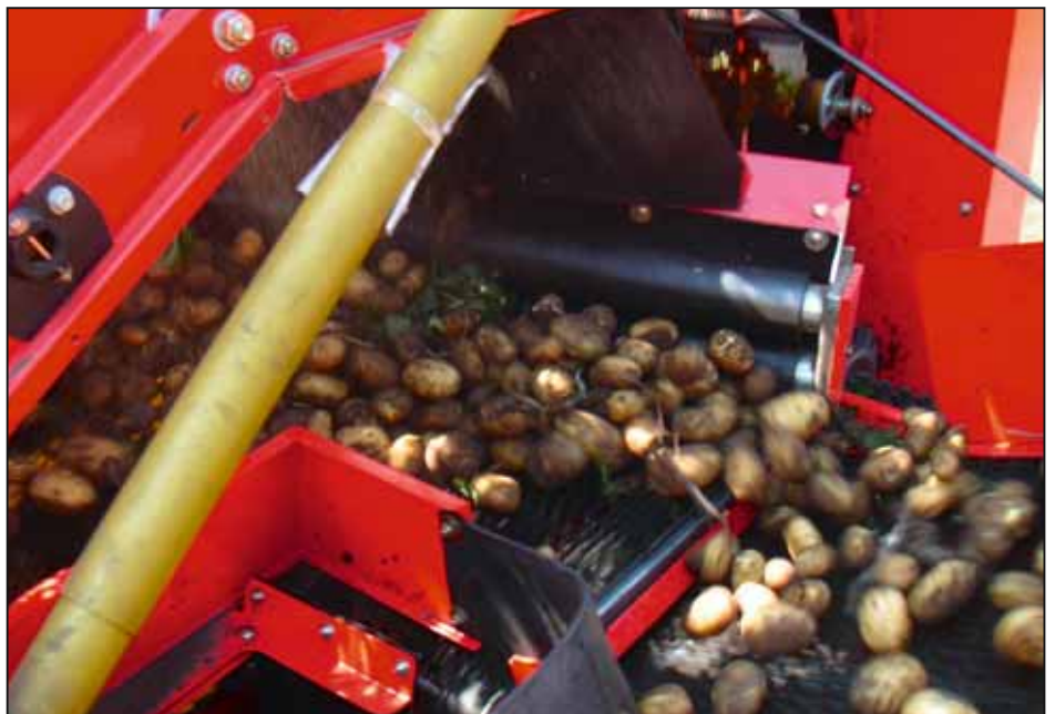
Manueel instelbaar: de 6 afstrijkkassen (3 boven en 3 onder) op de loofband
