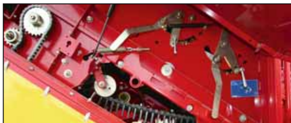
Manueel instelbaar: de 6 afstrijkkassen (3 boven en 3 onder) op de loofband
