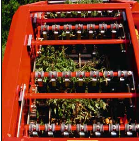
Optimale productvriendelijkheid: Loofband met zachte PU-meenemers (steek 210 mm of 280 mm naar keuze)
