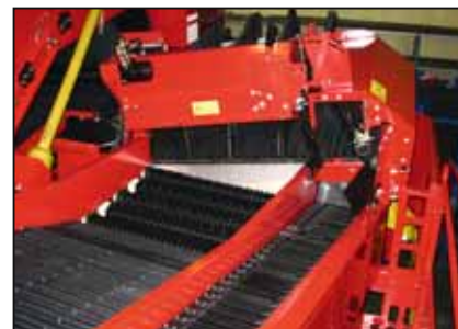
Nog effectiever: de 5-rollen voorsortering
