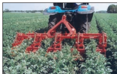
Ook bij reeds hoog staand opkomend gewas functioneert deze Grimme rugvormer probleemloos.
