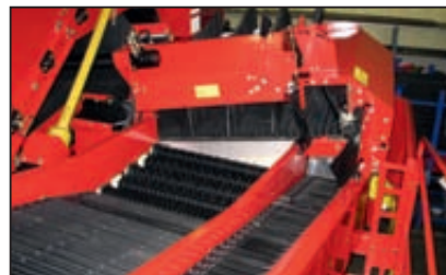
Più efficace: la cernita preliminare a 5 rulli
