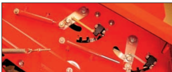
Come opzione la regolazione continua per mezzo della tecnica digitale: le 6 file di palette ferma patate (3 nella parte alta e 3 in quella bassa) sul nastro tiraerba.
