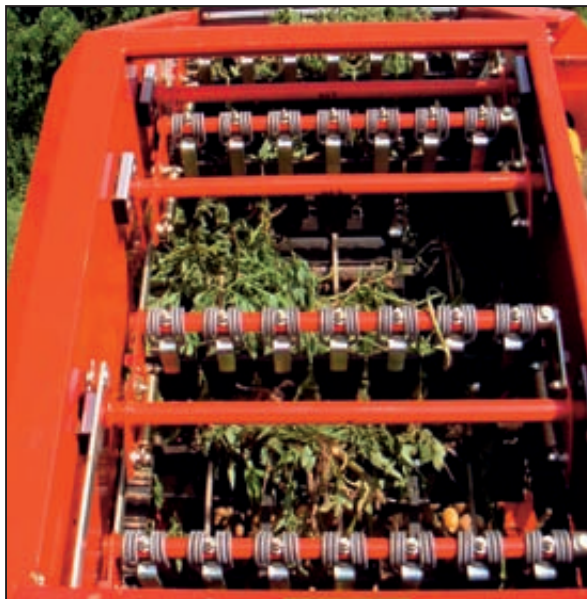
Trattamento ottimale del prodotto: nastro tiraerba con morbide alette in poliuretano (distanza 200 o 280 mm)
