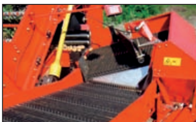
Tipo NB: riccio e doppio rullo tramite motrici l'impianto idraulico del trattore.
