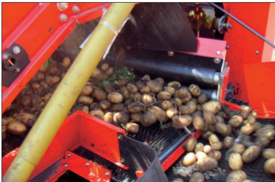
Come opzione la regolazione continua per mezzo della tecnica digitale: le 6 file di palette ferma patate (3 nella parte alta e 3 in quella bassa) sul nastro tiraerba.
