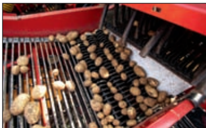
Conveniente: la cernita preliminare a 3 rulli
