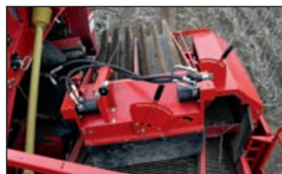
SB900, nastro a spazzola doppio (optional): aumenta la separazione su terreni con sassi
