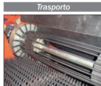
Separazione efficace dello scarto e trasporto dolce del prodotto in una sola fase.
