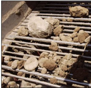
Var sjätte spole har en diameter på 16 mm. Detta ger tre avgörande fördelar: Materialtransporten på sållmattorna optimeras, krossningen av jordkokorna stöds och man får en bättre, övergripande bandstabilitet när stenarna är stora.
