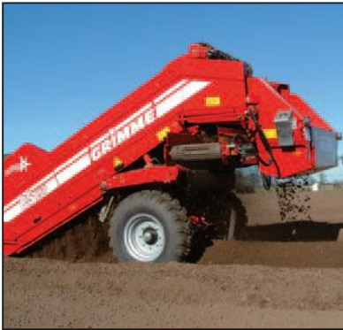
Alla modeller är som standard utrustade med ett utmatningsband med 22 mm delning mellan spolarna.
