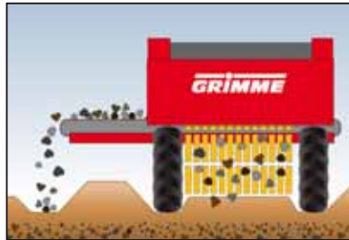
Fase 2: Separering med Strenglæggeren fra CS/CW-serien. Strenglæggeren indfører hele bedet, og separerer jord, knolde og sten.
