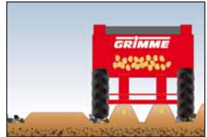
Fase 3: Kartofler lægges med Bedlægger. Efter separeringen lægges kartoflerne i 1-, 2- eller 3 bede på én gang.
