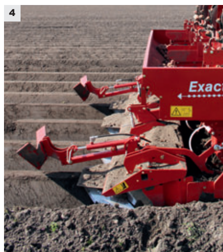
Mængden i elementet (3) styres via sensorer. Umiddelbart efter kartoflens placering bygger kamformerpladen (4) kammen op.
