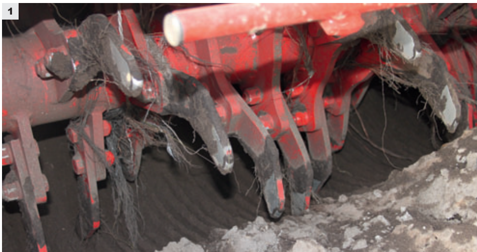
GR 300 arbejder i læggerens fulde bredde (1). 110 tænder er monteret i spiralform, hvilket giver støt og stabilt arbejde.
