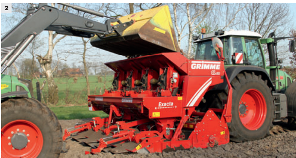
En slidske (2) giver skånsom påfyldning med frontlæsser eller påfyldningsbånd.
