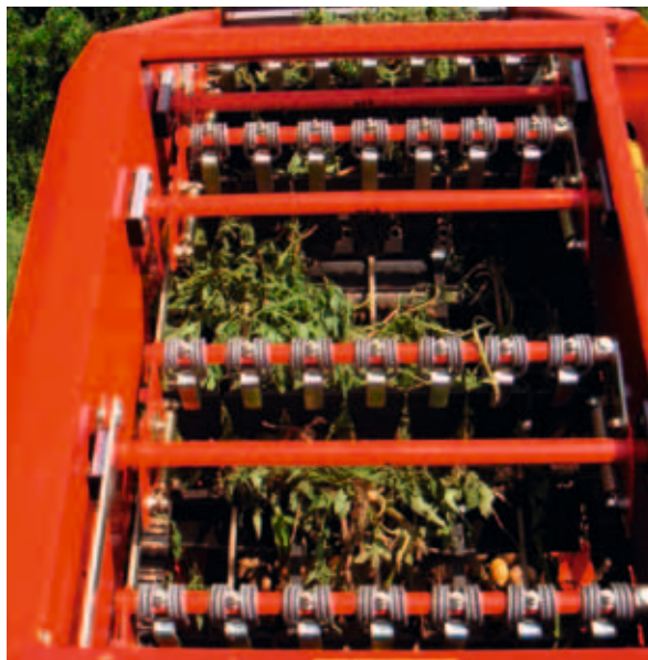
Optymalna ochrona produktu: Taśma łęczinowa z delikatnymi zabierakami (odstępów po 210 mm, 280 mm)
