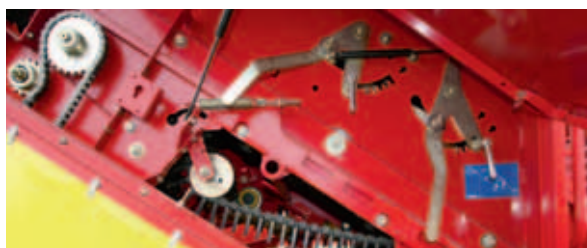
Ręczna regulacja: ustawienie 6 grzebieni zatrzymujących (po 3 u góry i 3 u dołu) nad taśmą łęczinową.
