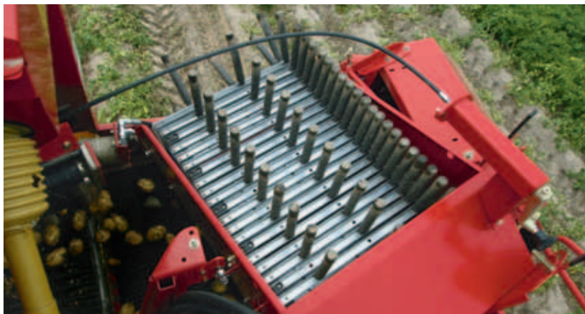
Prędkość taśmy palcowej reguluje się w płynny sposób hydraulicznie.
