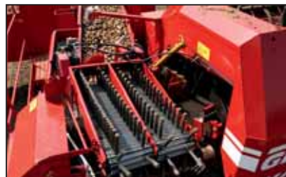
UB 900, dobbelt fingerbelte (ekstrautstyr): økt utskillerresultat på klumprik jord
