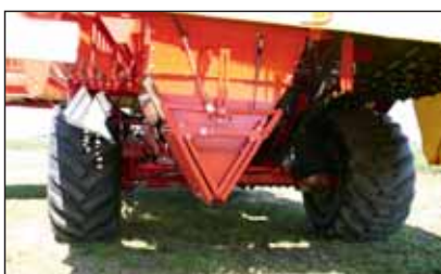
Samletank under sorteringsvalsene
