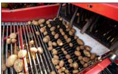
Ekstra: For-sortering med 3 sorteringsvalser
