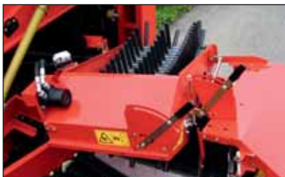
Hastigheten på fingerbeltet reguleres trinnløst takket være den hydrauliske driften.
