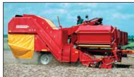
SE 75-40: for store arealer, oversiktlig oppbygging, rullebunnstank for 4.000 hhv. 4.300 kg.
