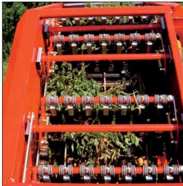
Optimal beskyttelse av avlingen: grovrisbelte med myke PU-medbringere (210 mm eller 280 mm avstand)
