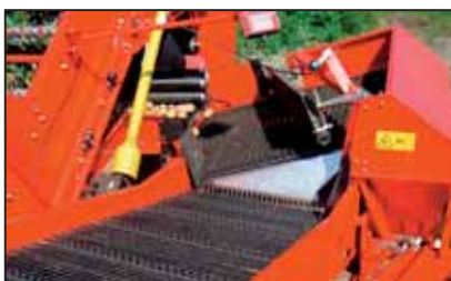
Type NB: fingerbelte og avskrapervals drives av traktorens hydraulikksystem.
