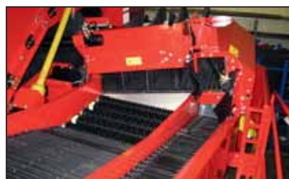
For-sortering med 5 sorteringsvalser
