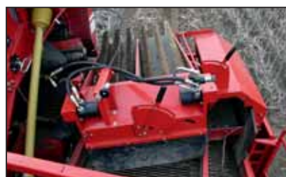
SB 900, dobbeltbørster (ekstrautstyr): øker utskillerresultatet på steinrik jord
