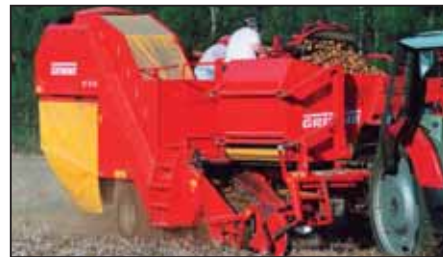
SE 75-30: for middels til store arealer, kompakt og oversiktlig oppbygging, rullebunnstank for 3.000 hhv. 3.300 kg.
