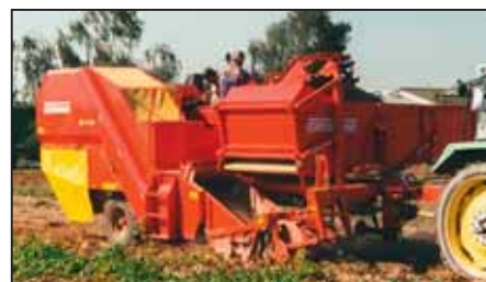
SE 75-20: for mindre opp til middels store arealer, særlig kompakt og lavt design, rullebunnstank for 2.000 hhv. 2.300 kg
