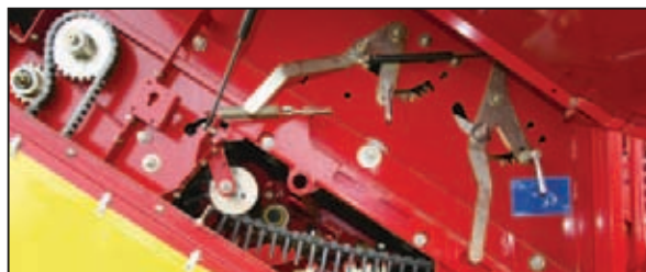
Manuell einstellbar: die 6 Rückhaltekäme (jeweils 3 oben und 3 unten) auf der Krautkette
