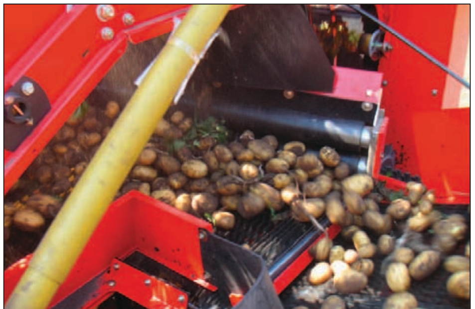
Effektive Beimengentrennung und schonende Produktbeförderung in Einem
