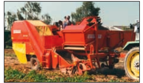
SE 75-20: für kleine bis mittlere Anbauflächen, besonders kompakte (niedrige) Bauweise, Rollbodenbunker für 2.000 bzw. 2.300 kg
