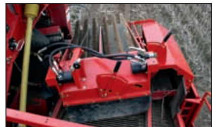
SB 900, Doppelbürste (Option): Steigerung der Trennergebnisse auf steinreichen Böden
