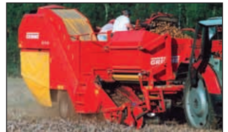
SE 75-30: für mittlere bis große Anbauflächen, kompakte (übersichtliche) Bauweise, Rollbodenbunker für 3.000 bzw. 3.300 kg
