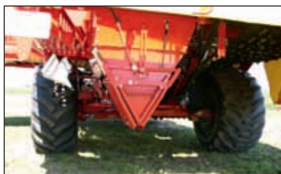
Optionaler Sammelbehälter unter der Walzensvorsortierung
