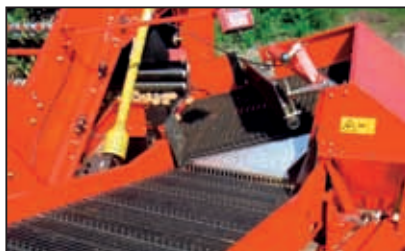
Typ NB: Antrieb von Igelband und Abstreiferwalze erfolgt über die Schlepperhydraulik.
