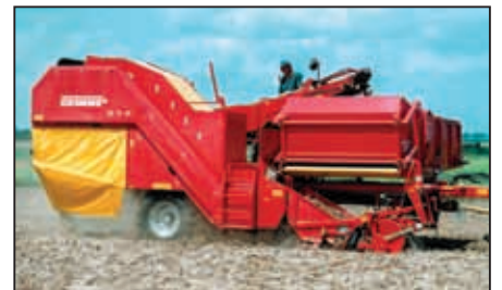
SE 75-40: für große Anbauflächen, übersichtliche Bauweise, Rollbodenbunker für 4.000 bzw. 4.300 kg
