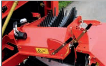
Die Geschwindigkeit des Fingerbandes ist stufenlos hydraulisch verstellbar.
