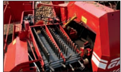
UB 900, Doppelfingerband (Option): Steigerung der Trennergebnisse auf klutenreichen Böden
